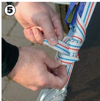
5. Die losen Gurtenden werden sorgfältig gesichert. Im 100-km/h-Fahrtwind würden sie sonst zu Peitschen und könnten sich eventuell sogar ganz lösen.
