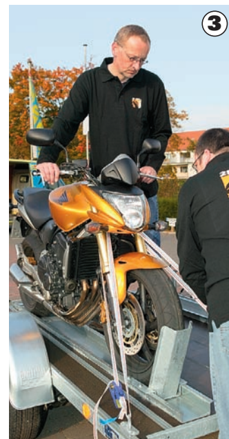
3. Beim Anbringen der vorderen Spanngurte sollte eine zweite Person das Motorrad sichern. Festgezogen wird abwechselnd links und rechts, bis die Gabel etwa zur Hälfte ihres Federwegs zusammengedrückt ist.
