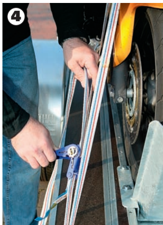
4. Die Spanngurte werden so justiert, dass das Motorrad senkrecht steht. Dabei darauf achten, dass der Gurt möglichst nicht am Motorrad scheuern kann.
