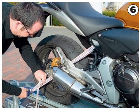
3. Beim Anbringen der vorderen Spanngurte sollte eine zweite Person das Motorrad sichern. Festgezogen wird abwechselnd links und rechts, bis die Gabel etwa zur Hälfte ihres Federwegs zusammengedrückt ist.
