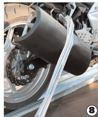
8. Auch die Auspuffmanschette schützt sowohl den Gurt als auch den Schalldämpfer, verhindert Kratzer und dämpft Vibrationen während der Fahrt in den Urlaub.
